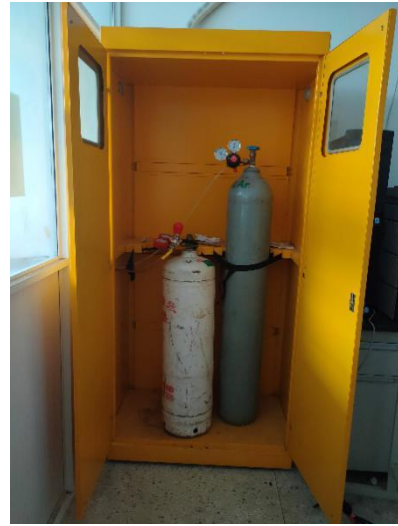
生科楼公共实验室 C6010—气体钢瓶未固定，已经 2 次告知整改，但仍未整改
