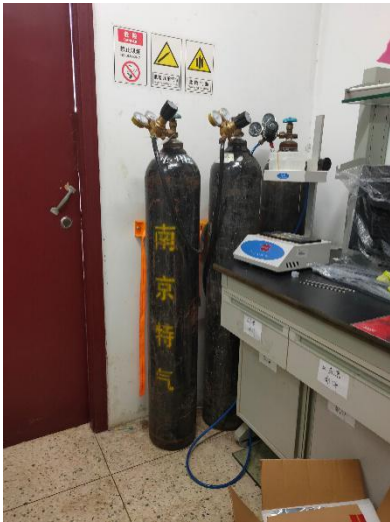
生科楼 C6008—气体钢瓶未固定，废胶桶无标签
