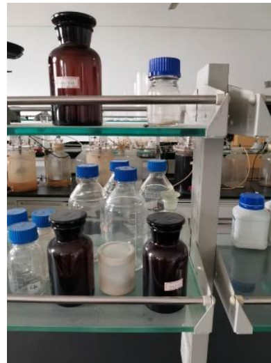
博远楼 A301—使用饮料瓶装试剂；实验用品多数未贴标签
