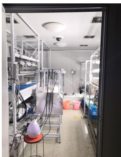
生科楼负 B1021—电线很多，接线板直接放置地面使用，门口滴水，地面潮湿；冰柜腐蚀且漏水， 负责人徐志刚
