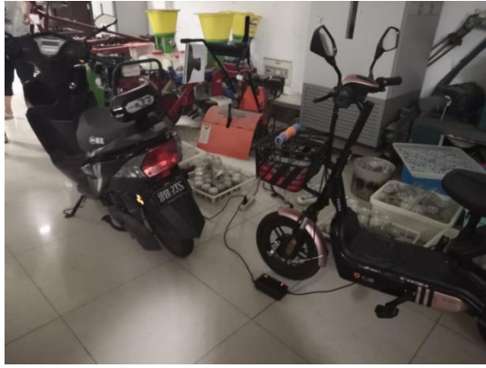
生科楼负 B1021—实验室内电动车充电 拖线板置于地上，负责人徐志刚
