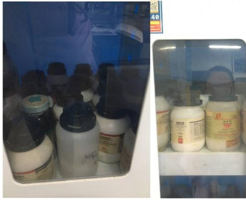
生科楼 A6014—多瓶硝酸盐未放入防爆柜中
