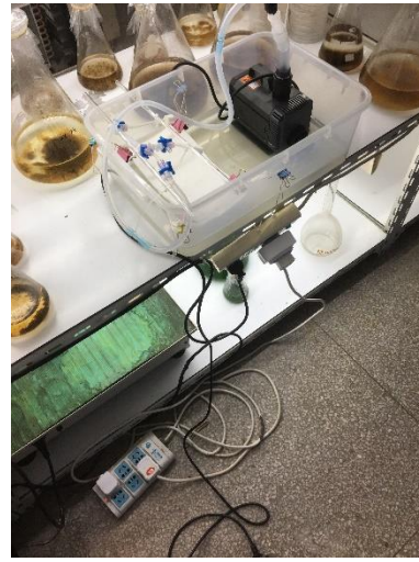
资环楼 A515—接线板放置地面且串联使用。负责人王长海(左边初查, 右边复查)
