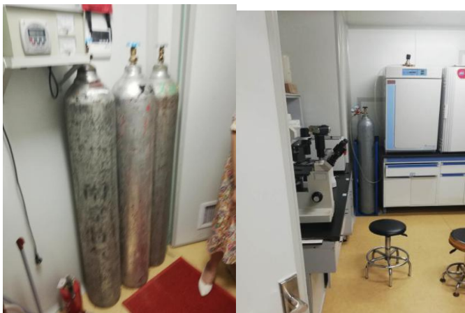
逸夫楼 4022 房间—有两处气体钢瓶未固定。负责人姜平（左边初查，右边复查）
