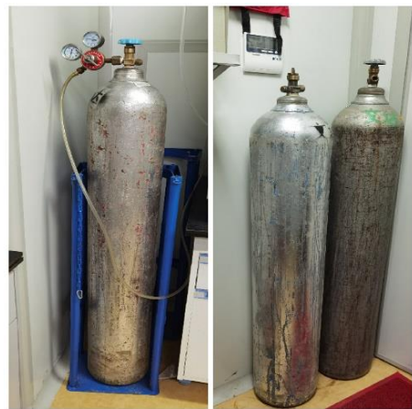
逸夫楼 4022 房间—有两处气体钢瓶未固定。负责人姜平（左边初查，右边复查）
