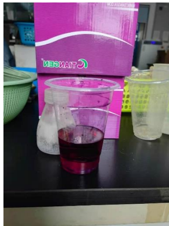
理科楼 B613—废液桶下方未配备防漏托盘；用一次性水杯装不明液体，无任何标签； 桌面上放有用矿泉水瓶未贴任何标签 负责人胡白石
