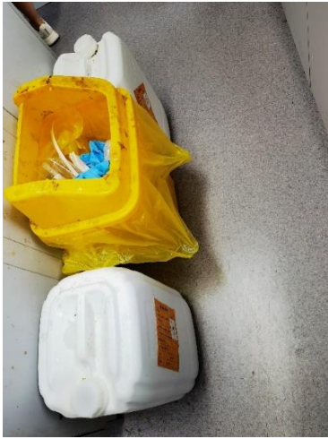
理科南楼 F226—实验室废弃物收集区未张贴警示标识和警示带；废液桶下方未配备防漏托盘 负责人王源超
