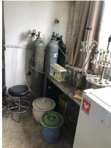
逸夫楼 2020—废弃物收集区未张贴警示标识和警示带；洗眼器不出水，下水不通；气瓶没有状态标识。 负责人余祖功
