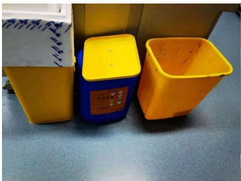
理科楼 B307—实验室废弃物收集区未张贴警示标识和警示带；废液桶下方未配备防漏托盘 负责人李保平
