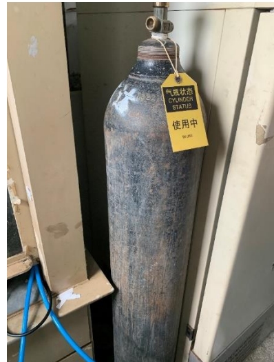
教十楼 3 楼楼道（335 门口）—楼道放置 3 个气瓶且未固定 负责人章建浩
