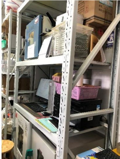
化学楼 416-烘箱周围放易燃物品，灭火器无架子和点检记录卡，负责人李翔
