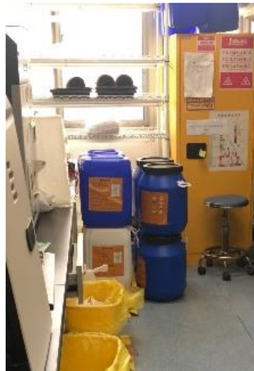
理科南楼 F330—易制爆危化品（过氧化氢）没有双人双锁，随意摆放在试剂架上；液氮罐未配备防冻手套；废液桶叠放；实验室废弃物专用垃圾袋存放杂物。负责人郭振飞
