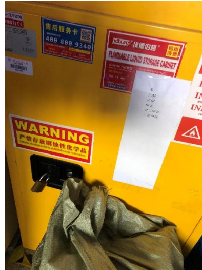
化学楼 422-实验室废液桶叠放, 易制毒危化品存储不规范, 安全柜选择不当, 负责人朱映光
