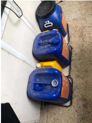
逸夫楼 2020—废弃物收集区未张贴警示标识和警示带；洗眼器不出水，下水不通；气瓶没有状态标识。 负责人余祖功
