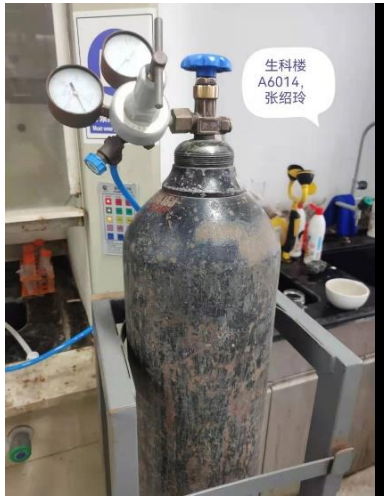
生科楼 A6014—气瓶无状态标签；灭菌锅使用未及时记录 负责人张绍玲
