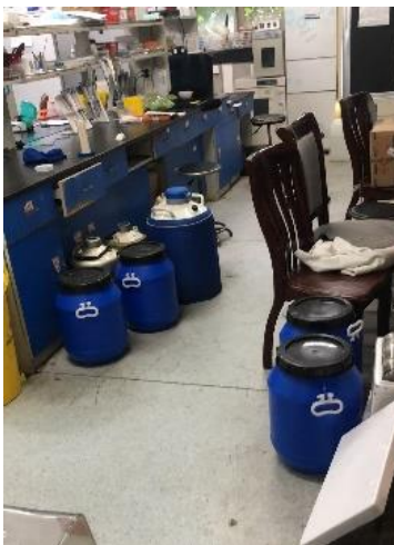
生科楼 B2020—实验室废胶桶太多且无危废标签；接线板用胶带粘在墙上，使用不规范；液氮罐罐未配备防冻手套。负责人房经贵
