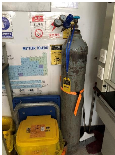
化学楼 415-灭火器无点检记录卡，气瓶使用状态错误，实际不在用，状态标签是“使用中”，负责人朱映光
