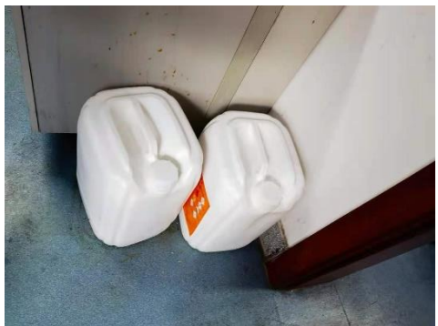
理科楼 B315—实验室废弃物收集区未张贴警示标识和警示带；废液桶下方未配备防漏托盘 负责人韩召军
