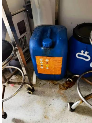
理科楼 B605—实验室废弃物收集区未张贴警示标识和警示带；废液桶下方未配备防漏托盘；接线板直接置于地面使用；负责人窦道龙
