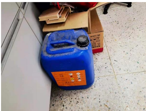
理科楼 B303—废液桶下方未配备防漏托盘； 食用类的蜂蜜直接摆放在实验室试剂架上，无任何标签（经了解是养虫子用的） 负责人王备新
