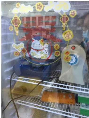
逸夫楼 4061—仪器设备外接电源放置于冰箱使用 负责人范红结
