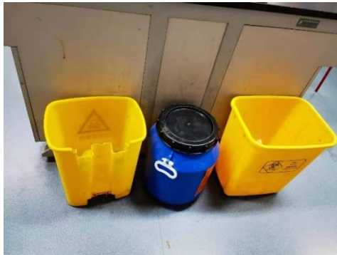
理科楼 B315—实验室废弃物收集区未张贴警示标识和警示带；废液桶下方未配备防漏托盘 负责人韩召军
