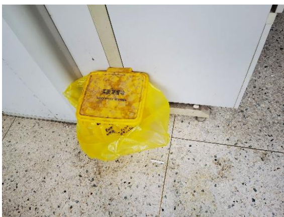
理科楼 B307—实验室废弃物收集区未张贴警示标识和警示带；废液桶下方未配备防漏托盘 负责人李保平
