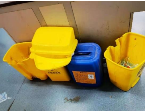
理科楼 B307—实验室废弃物收集区未张贴警示标识和警示带；废液桶下方未配备防漏托盘 负责人李保平
