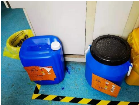
理科楼 B613—废液桶下方未配备防漏托盘；用一次性水杯装不明液体，无任何标签； 桌面上放有用矿泉水瓶未贴任何标签 负责人胡白石
