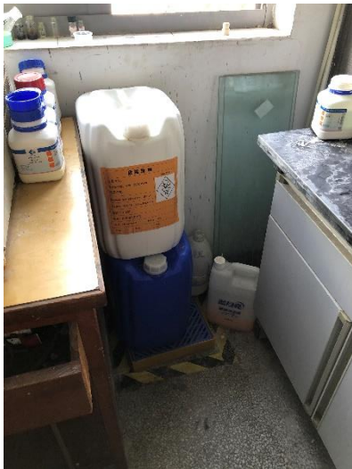
化学楼 422-实验室废液桶叠放, 易制毒危化品存储不规范, 安全柜选择不当, 负责人朱映光
