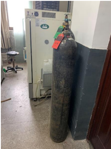
教十楼 3 楼楼道（335 门口）—楼道放置 3 个气瓶且未固定 负责人章建浩
