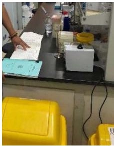
逸夫楼 2018—烘箱没有警示标识，没有使用登记；灭菌锅没有使用登记证，危化品存放不合理。 负责人余祖功
