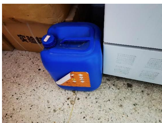
理科楼 B307—实验室废弃物收集区未张贴警示标识和警示带；废液桶下方未配备防漏托盘 负责人李保平
